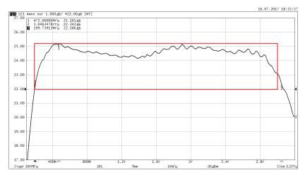
АЧХ приёмо-передающей линии в полосе 0 - 3.2 ГГц. (Одна клетка по горизонтали - 400 МГц.,одна клетка по вертикали - 1 дБ).
